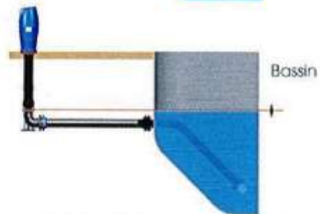
Principe d'implantation d'un poteau d'aspiration à réseau sec.
