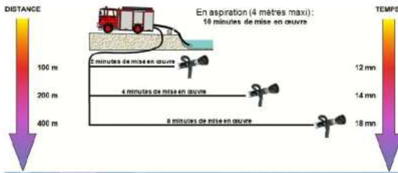
Alimentation d'un engin pompe sur une réserve incendie.
